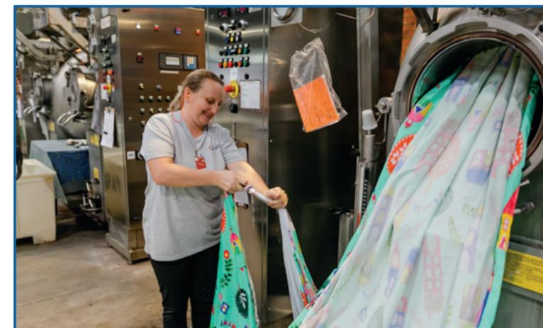
Máquinas de tingir com relação de banho reduzidas: usam menos água para tingir um quilo de malha.
